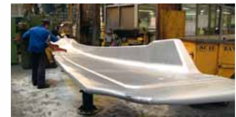
AUBERT & DUVAL Airbus A380 Pièce de jonction aile-fuselage en aluminium
