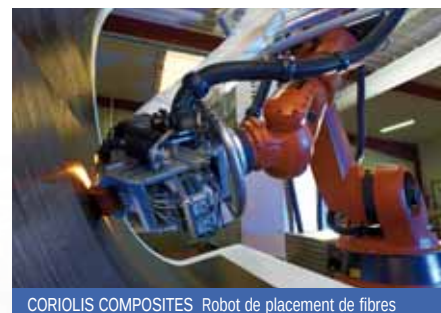
CORIOLIS COMPOSITES Robot de placement de fibres
