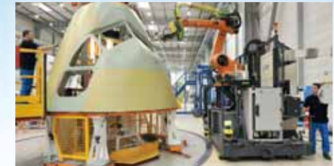
AEROLIA Assemblage robotisé d'un cockpit Airbus A320
