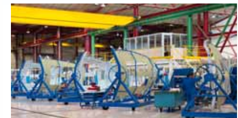
POTEZ AERONAUTIQUE Ateliers d'assemblage de panneaux A330
